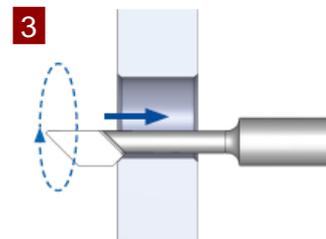
Plonger uniquement jusqu'à ce que l'outil bascule vers l'extérieur et que le col étagé de l'outil soit en contact avec l'alésage. Puis reculer de l'alésage avec une faible avance, en fonction de l'intensité d'ébavurage souhaitée (env.  $F=80$ ). La bavure est ainsi éliminée, car l'arête de coupe est pressée par la force du ressort sur l'arête à ébavurer. Dès que la surface de coupe est libre, sortez du trou en avance rapide.
