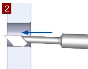
Plonger dans le trou avec l'outil en rotation et en avance rapide. Le bord avant de l'outil est arrondi pour permettre une plongée facile et éviter d'endommager le chanfrein extérieur.
